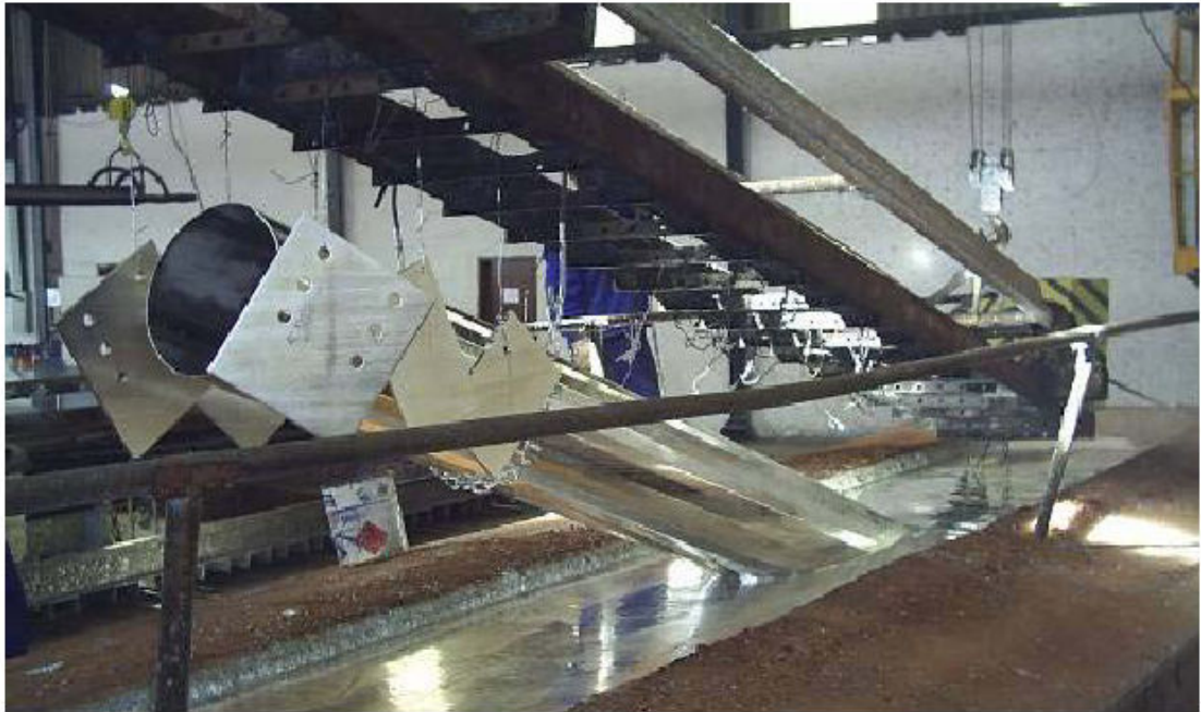
Figura 8.13 – Imersão de peças em uma cuba com zinco à temperatura entre 430 a 470°C.
