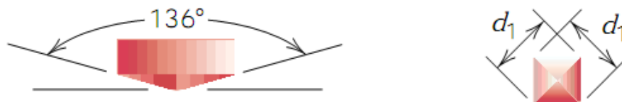
Figura 6.9 – Penetradores utilizados nos ensaios de dureza Knoop e Vickers
